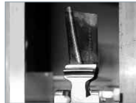
Turbine blade: 60kV; 0,5 mA
