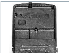
Al housing: 80kV; 0,5 mA
